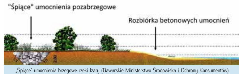
„Spiące” umocnienia brzegowe rzeki Izary (Bawarskie Ministerstwo Środowiska i Ochrony Konsumentów).
